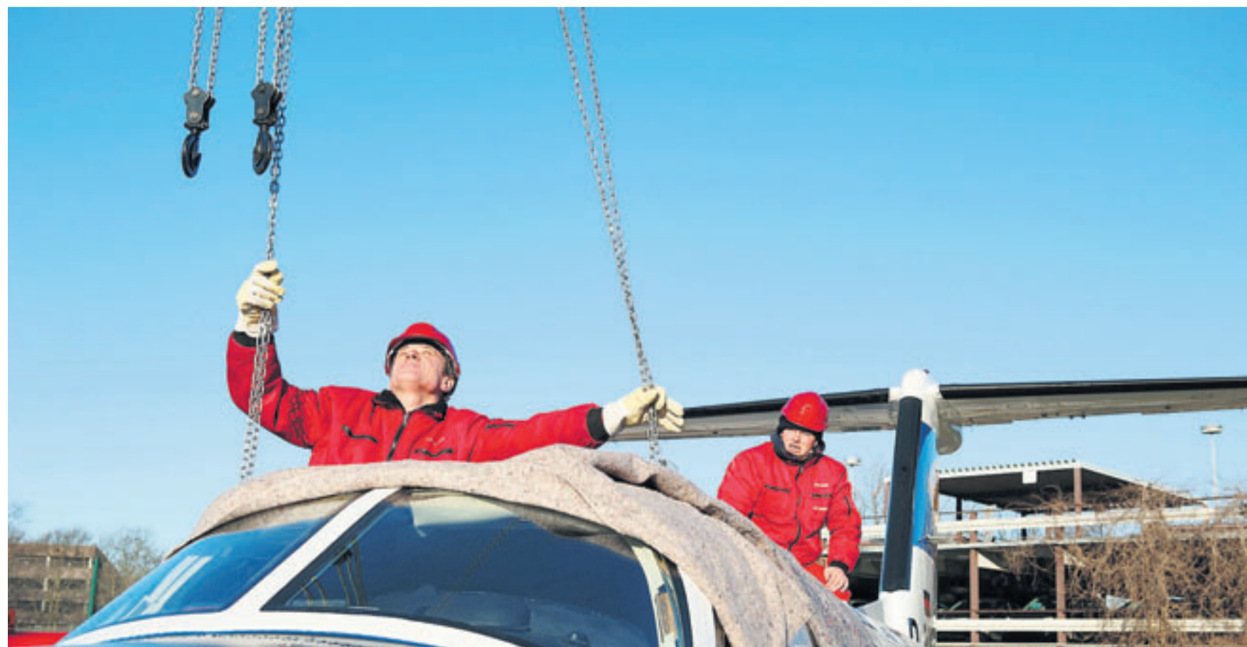
Das Schwerlastteam von Oliver Fleischer hat den Großteil des Flugzeugzugs nachts organisiert. Damit beim letzten Hebeanöver der Lack nicht verkratzt, schützen Decken die empfindliche Oberfläche. Vorarbeiter Ewald Lenz (links) und Mitarbeiter Peter Klein übernehmen vom Megalift-Kran die Kettenseilzüge.
