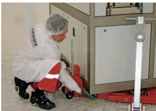
... anschließend wird die 2 t schwere Einheit passgenau vom Rollersatz abgesetzt.
