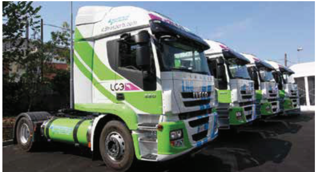
Vier von fünf Stralis AT440S33T/P LNG Sattelzugmaschinen mit 330 PS für LC3-Transporte
